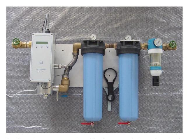
Estación completa y compata para la potabilización de aguas pluviales mediante filtración multiple y desonfección por rayos UV-C, lista para su uso inmediato
